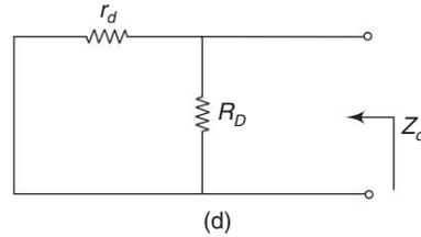
**Fig. 3.4** (d) Equivalent circuit for output impedance
