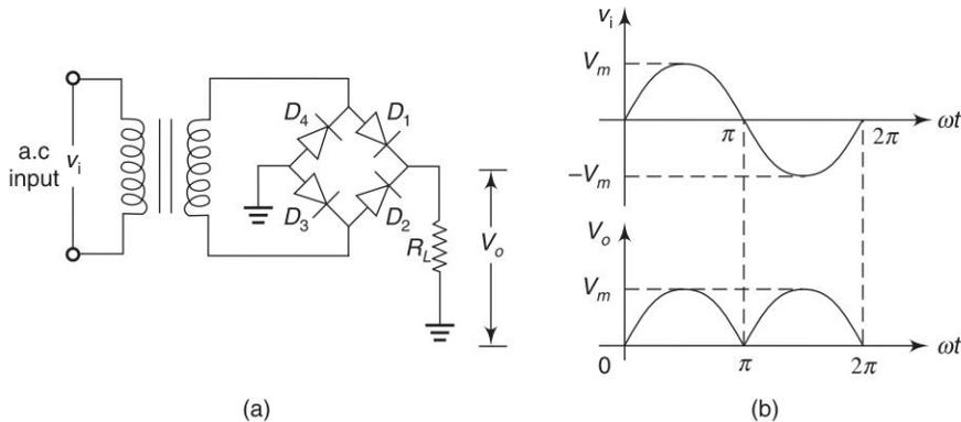
Fig. 5.5 Bridge rectifier
