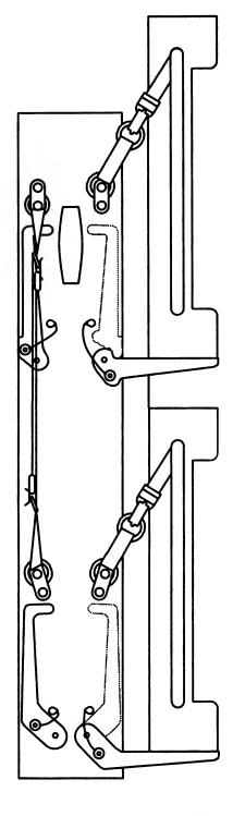
LEFT SIDE SHOWN STOWAGE ASSEMBLY STOWED AND STRAPS STOWED RIGHT SIDE SHOWN LITTER SUPPORTS STOWED WITH STRAPS
