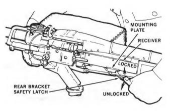
STEP 2 REAR BRACKET SAFETY LATCH LOCKED POSITION
