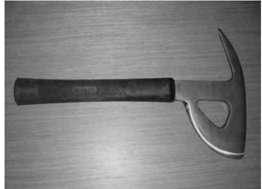
Fig. 7.4 Fire Axe/Crash Axe
